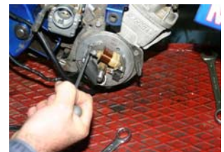
Déposer les vis de fixation du stator.
