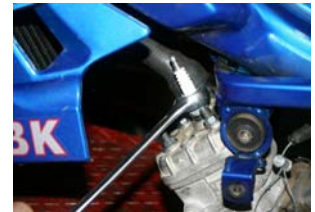
Retirer la bougie avec une clé de 21.
