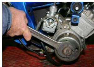
Tourner le rotor dans le sens inverse jusqu'à son blocage et desserrer l'écrou avec une clé de 32.
