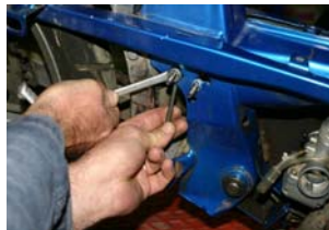
Positionner les 2 vis BTR 6x35 avec les écrous, rondelles et contre écrou fournie pour faire un support à la bobine haute tension du Millénium MVT
