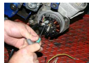
Fixer le stator sur la platine avec les 3 vis 4x30 fournies.
