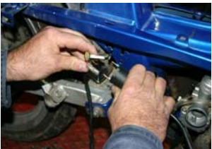
Déposer la bobine haute tension d'origine.
