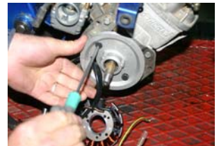
Fixer la platine avec les 2 vis 6x20 têtes fraisées en contrôlant qu'elle plaque bien contre le carter moteur et qu'aucune vis de carter ne gêne.
