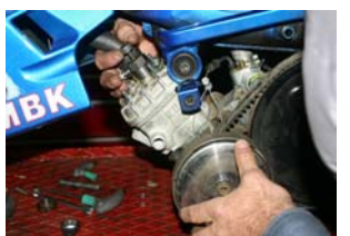
Faites tourner le moteur dans le sens de rotation en desserrant la vis de réglage de la pige de calage jusqu'à ce que le piston vienne au point mort haut. Une fois trouver le point mort ne toucher plus à la pige de calage et continuer à faire tourner le moteur d'un demi tour.
