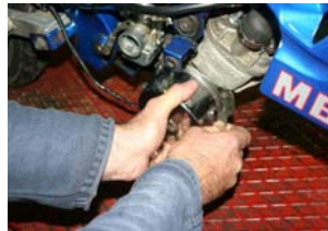
Dépose du cache allumage.
