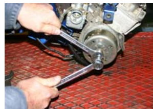
Présenter l'extracteur MBK et débloquer le rotor avec les clés correspondantes.
