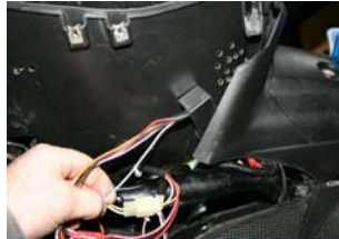
Placer le diagramme entre les caches et si possible, le fixer le un collier plastique.
