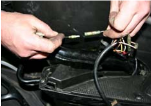
Brancher le câble noir/blanc du diagramme avec le noir/blanc du faisceau.
