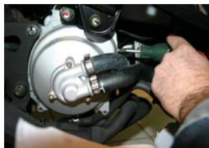
Repositionner les 2 vis de fixation du cache allumage avant avec un tournevis cruciforme.
