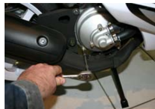
Repositionner les vis inférieures et supérieures du couvercle de pompe à eau avec une clé allen de 5.
