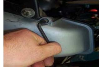
Repositionner le cache allumage avec ses vis et une clé allen de 5.
